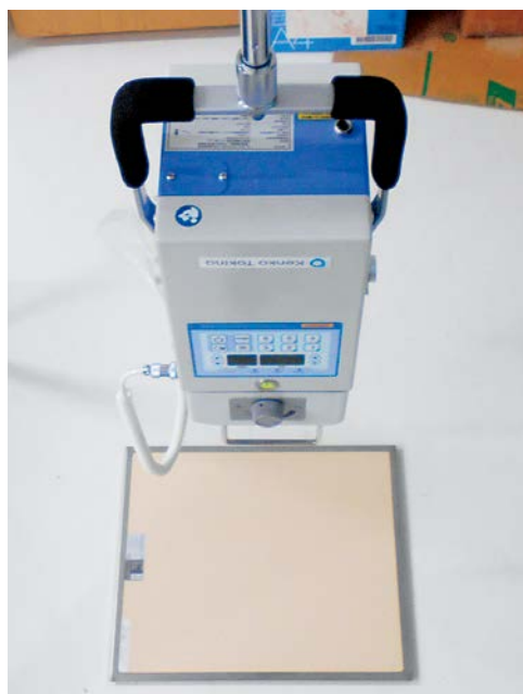
上が携帯型X線発生装置 この発生装置と受信用のパネルの間に撮影対象物を置き撮影すると画像が出てくる
