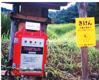
電気防護柵 電気柵バッテリー・電池
