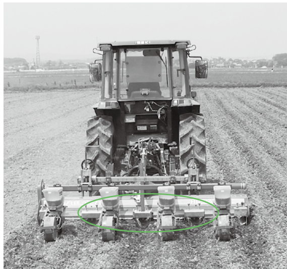
写真 簡易畝立機「ちかのりくん」 県農林水産研究指導センター農業研究部水田農業グループ作物栽培チームの近乗 ちかのり 大 ちかお 偉 ちかお 夫 ちかお 主 ちかお 幹 ちかお 研究員が平成18年に開発。三角すいの形をした鉄製の畝立て機で、ロータリーカバーにボルトで固定する。
