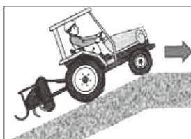
作業機を下げ、傾斜に対して直角の向きで入退しましょう
